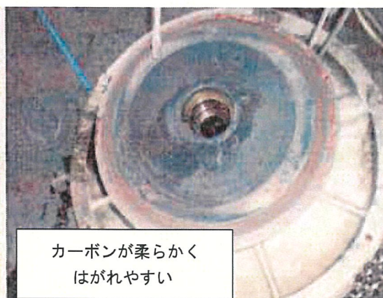
換気口のカーボン も簡単に剥がれ 落ちる状態
